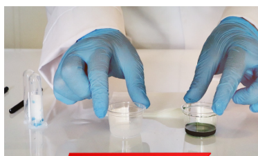
Påvisning av karbondioksid med kalkvann
